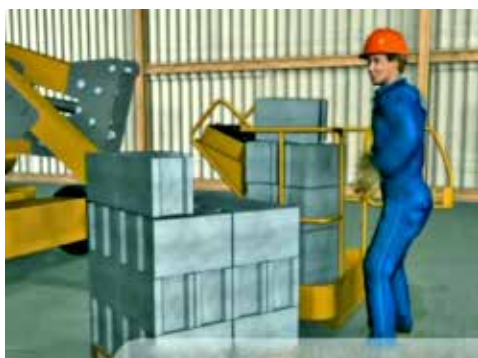
Figura 17. Plataforma de trabajo sobrecargada.
