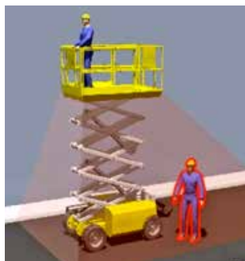
Figura 22. Control de presencia de operarios en proximidad.
