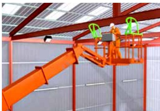
Figura 26. PEMP con sistema antiatrapamiento.
