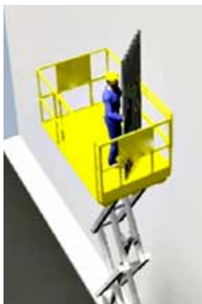
Figura 28. Aumento de la resistencia al viento.
