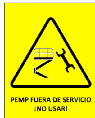
Figura 24. Señal de PEMP fuera de servicio.
