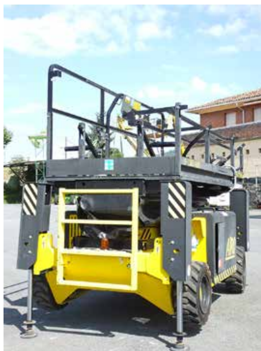
Figura 6. Plataforma de trabajo con protecciones perimetrales plegables.
