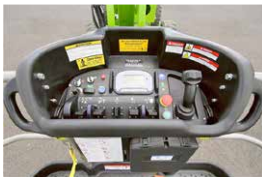
Figura 10. Mando primario sobre plataforma de trabajo.
