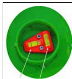
Figura 1. Nivel de burbuja longitudinal y transversal del chasis.
