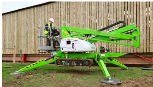
Figura 15. Estabilizadores hidráulicos con placa de apoyo.
