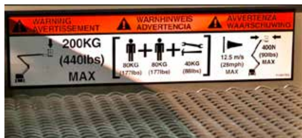
Figura 9. Señalización de carga nominal, número máximo de personas y equipo de trabajo, velocidad máxima del viento y punto de anclaje solo para retención.
