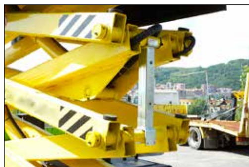
Figura 16. Sistema mecánico de seguridad. Detalle.
