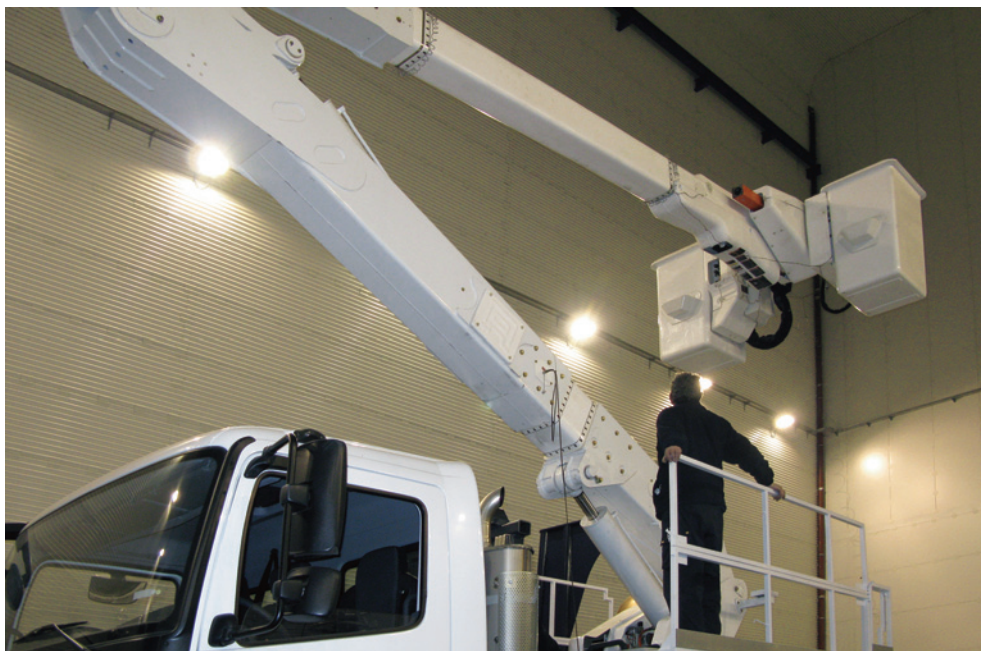
Ilustración 11: plataforma aislante durante la realización de los ensayos de aislamiento conforme a la norma UNE EN 61057:1996 “Elevadores de brazo aislante utilizados para los trabajos en tensión superior a 1KV en corriente alterna” y UNE EN 61057:1996 CORR:2006
