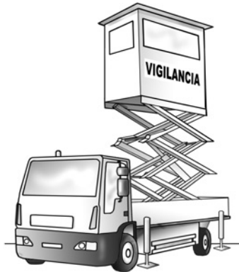
Ilustración 9: ejemplo de garitas y torres de vigilancia, sobre vehículo o autopropulsadas
